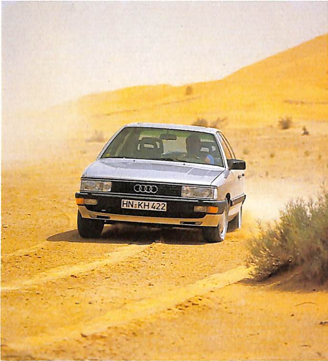
Testfahrten unter extremen Umgebungsbedingungen gehören zur Erprobung der Gesamtanlage, da sich Straßenverhältnisse in letzter Konsequenz nicht voll simulieren lassen. Das Foto zeigt ein Fahrzeug für die Prüfung von Heißstart- und Heißfahrverhalten in der Sahara.
