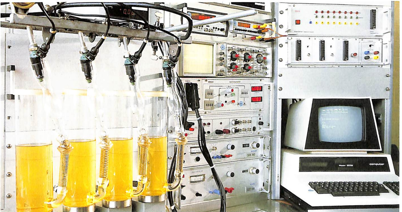
Auf dem Benzinkreislauf-Prüfstand wird kontrolliert, ob der Kraftstoff gleichmäßig auf die einzelnen Zylinder verteilt wird.
