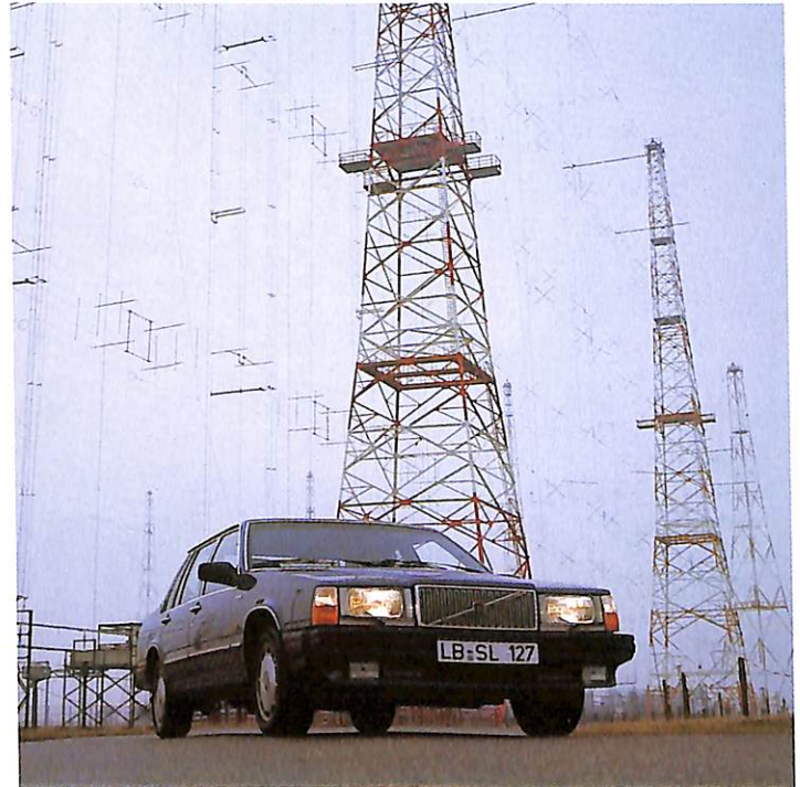
Unter den Masten eines Großsenders wird die Störsicherheit der Benzineinspritzanlage bei starker elektromagnetischer Einstrahlung überprüft. Erst nach Abschluß dieser Prüfungen erfolgt die Systemfreigabe – und damit der Start zur Serienfertigung.
