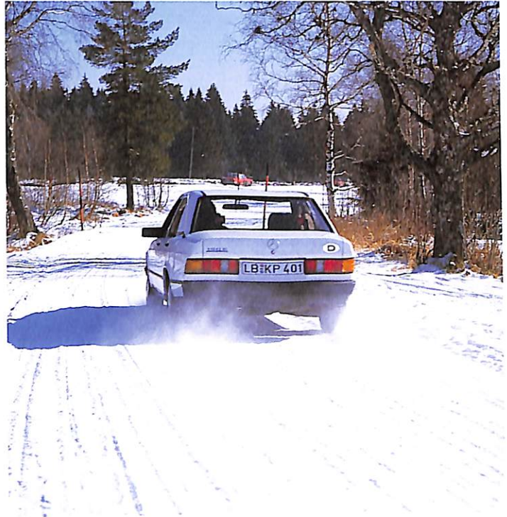
Die Testfahrten werden häufig mit dem Fahrzeug-Hersteller zusammen unternommen. Hier wird zum Beispiel das Kaltstart- und Warmlaufverhalten bei extrem niedrigen Temperaturen in Nordschweden getestet.
